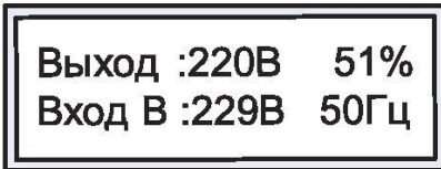
Рисунок 6б. ЖК-дисплей в режиме основного экрана (отображение входных и выходных параметров фазы В)
