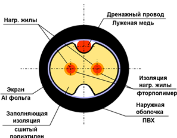
Рис. 2. Устройство нагревательного кабеля ДЕВИ Snow-30Т
