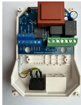
Фото 2. Блок управления GIDROLOCK STANDARD со снятой крышкой
