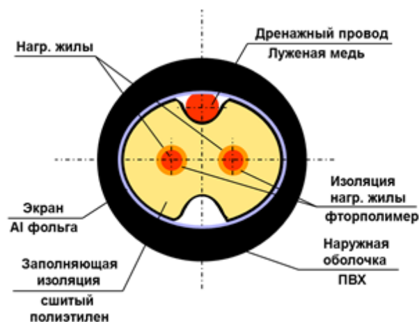
Рис. 2. Устройство нагревательного кабеля ДЕВИ Snow-30Т
