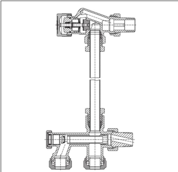
Вентиль для однотрубных систем отопления „Bypass-Combi Uno“. Монтажный набор для установки в однотрубных системах отопления.
