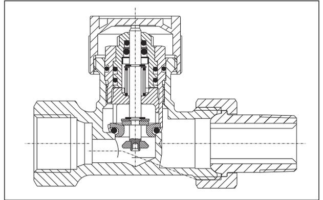
Модель с плавной преднастройкой и двойной функцией. Двойная функция, при которой в случае демонтажа или повреждения термостатической головки вентиль автоматически переводит величину пропускания на 5% от номинального.
