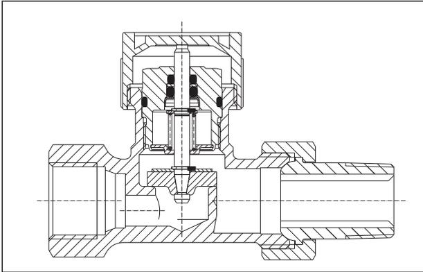
Модель для однотрубных и двухтрубных систем отопления. Настройка расхода производится на вентилях на обратную подводу с функцией преднастройки (напр. „Combi 4“).
