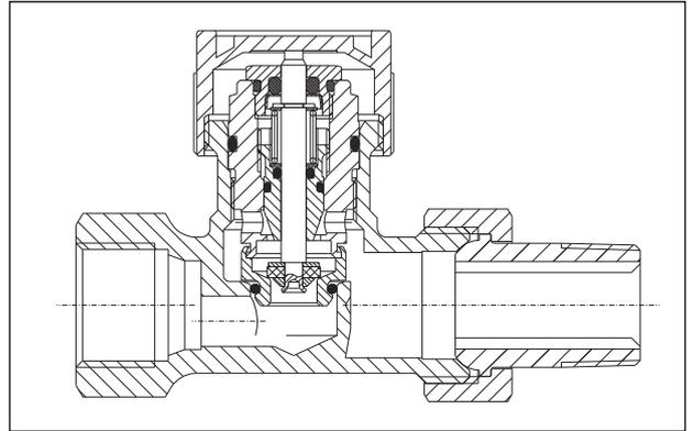
Модель с плавной преднастройкой; для двухтрубных систем отопления с большим температурным перепадом и малым расходом.
