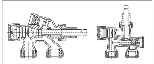
Погружные вентили для однотрубных систем отопления
