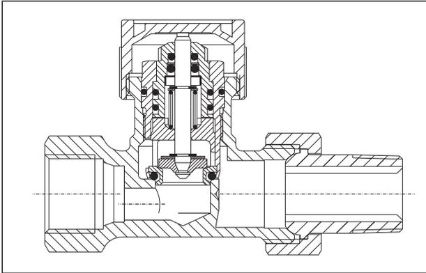
Модель с плавной преднастройкой; для двух трубных систем отопления с нормальным температурным перепадом. Вентили серий „AV9“, „RFV9“ und „CV9“ имеют преднастраиваемую вентиляющую вставку, за счет чего можно настроить необходимый расход.
