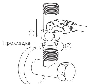
д. Соедините шланг холодной воды с трехходовым шаровым краном и плотно закрутите гаечным ключом. Пожалуйста, во время установки не забудьте про уплотняющую прокладку в шланге для холодной воды.
