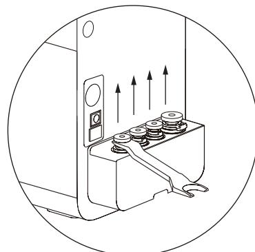
б. Соедините впускное отверстие для воды и трехходовой шаровой кран.
