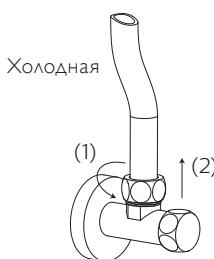
б. Наденьте гайку трехходового шарового крана на полиэтиленовую трубу 3/8" (9,525 мм) и вставьте трубу в отверстие трехходового шарового крана. Затяните гайку гаечным ключом.
