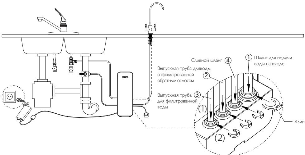
ф. Переместите систему на свое место в тумбу под раковиной и поместите датчик протечки рядом с системой на сухом полу.
